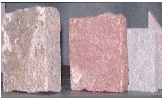
Εικόνα 5. Κυβόλιθοι φυσικού πετρώματος γρανίτη διαστάσεων 10x10x6εκ. σε ποικίλα χρώματα
