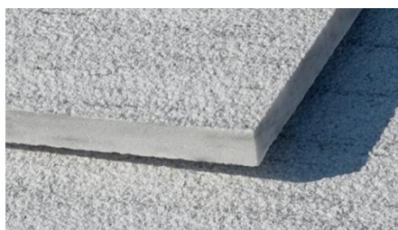
Εικόνα 8. Πλάκα από φυσικό πέτρωμα μαρμάρου χρώματος λευκού με σαγρέ επιφάνεια, διαστάσεων 40x40x5εκ.
